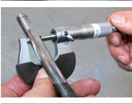
As hastas das válvulas não devem apresentar qualquer desgaste visível. O diâmetro e o comprimento da haste da válvula devem corresponder às indicações do fabricante (manual de oficina).
