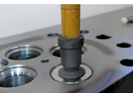
Em caso de fugas, verifique se as válvulas apresentam desvios de concentricidade e danos antes de recuperar os anéis de assento das válvulas ou de retificar as válvulas.
