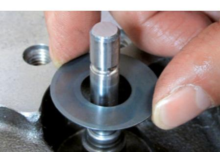
Lubrifique as hastas das válvulas antes da montagem final e insira as válvulas nas guias das válvulas. Instale os assentos das molas das válvulas ou os mecanismos de inclinação das válvulas (se aplicável).
