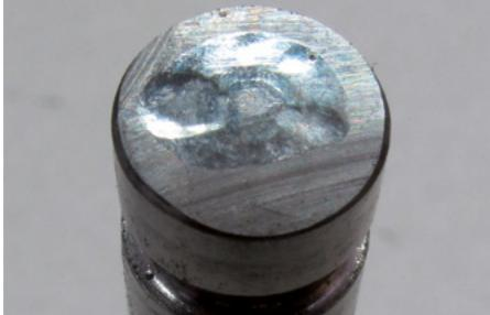
As extremidades da haste da válvula também não podem ser danificadas. Por conseguinte, recupere as superfícies da extremidade da haste da válvula danificadas ou substitua as válvulas.
