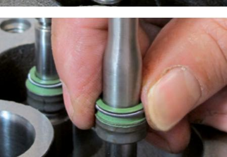
Faça deslizar os vedantes da haste da válvula sobre as hastas da válvula, utilizando um casquillo de proteção oleado.
