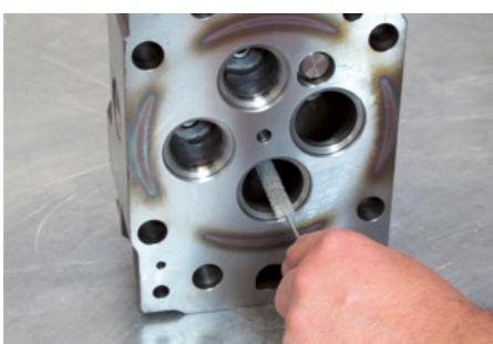
Desparafine, limpe e verifique as novas cabeças do cilindro quanto a danos externos. Limpe os orifícios do óleo e as guias das válvulas com uma escova.
