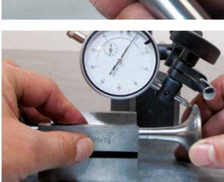
Verifique a concentricidade da superfície de assento da válvula com o prisma e o comparador. As válvulas dobradas devem ser obrigatoriamente substituídas.
