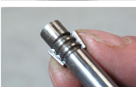
As áreas de fixação e as ranhuras dos cones das válvulas não devem apresentar danos nem rebarbas. A fixação efetiva nos cone das válvulas também deve estar adequada. Por razões de segurança, os cones das válvulas devem ser sempre trocados.
