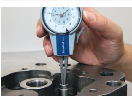
As dimensões do diâmetro da haste da válvula e da guia de válvula são subtraídas umas às outras e comparadas com as especificações de folga do fabricante. Se houver demasiada folga, a válvula pode estar gasta e deve ser substituída. Se a folga for demasiado pequena, a guia de válvula deve ser recuperada com um escareador.
