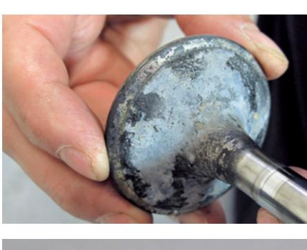
Os assentos das válvulas não devem ser partidos. Se tal acontecer: Substitua as válvulas ou recupere os assentos das válvulas com uma máquina retificadora de válvulas.
